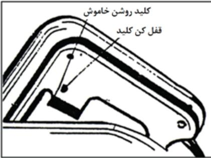
با فشار دادن کلید، دستگاه شروع به کار می‌کند و با رها کردن آن متوقف می‌شود. همچنین با فشار دادن دکمه قفل کن بعد از روشن کردن دستگاه در حالت روشن باقی می‌ماند و دستگاه به طور متناوب به کار خود ادامه می‌دهد تا وقتی که کلید را دوباره فشار دهید و متوقف شود.
